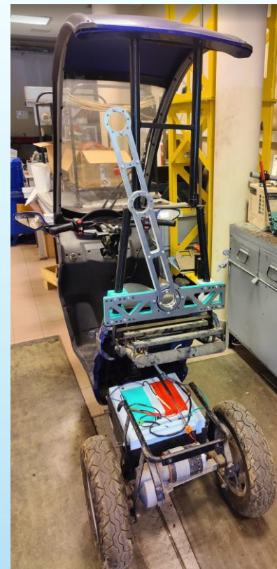
Odwzorowanie bezwładności kierowcy wahadłem odwróconym
